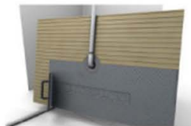
Peinar la base con cemento cola C2
