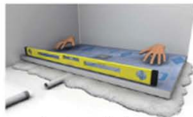
Asentar y nivelar sobre una base de mortero
